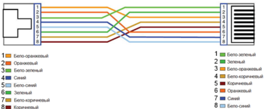
Рис. 12 Разводка кабеля по типу TIA/EIA-568-B.
