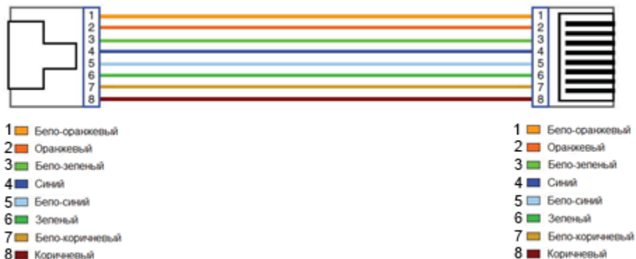
Рис. 10 Разводка кабеля по типу TIA/EIA-568-A.
